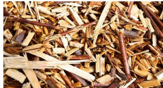
Densità apparente:  $650/750 \text{ kg m}^{-3}$
