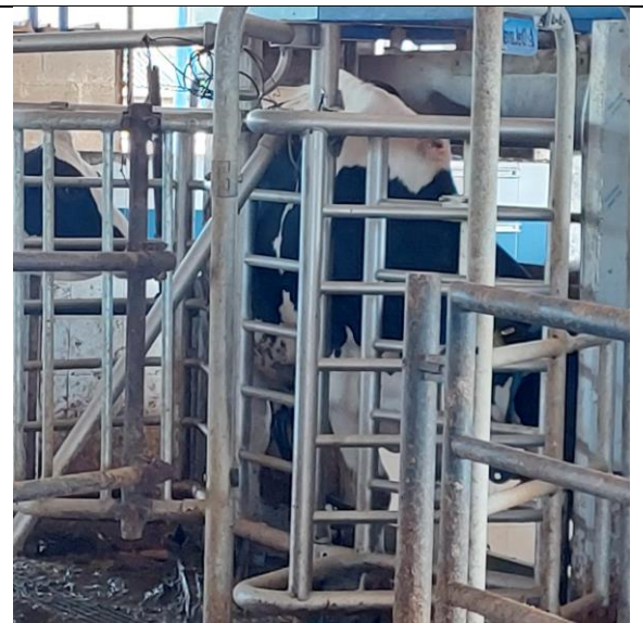
Foto 4 e 5. Bovini in stabulazione con orecchini e radiocollare. Quando la vacca sente il bisogno di essere munta entra nel percorso a tornelli che la indirizza fino alla postazione di mungitura.
