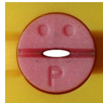
Stesso ugello AlbuZ dopo 50 ore di test
