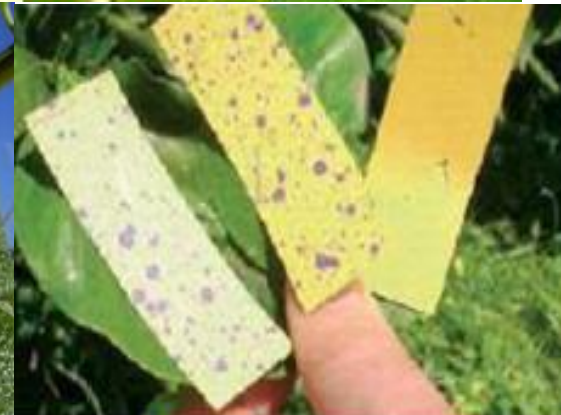
Copertura ridotta e non uniforme
