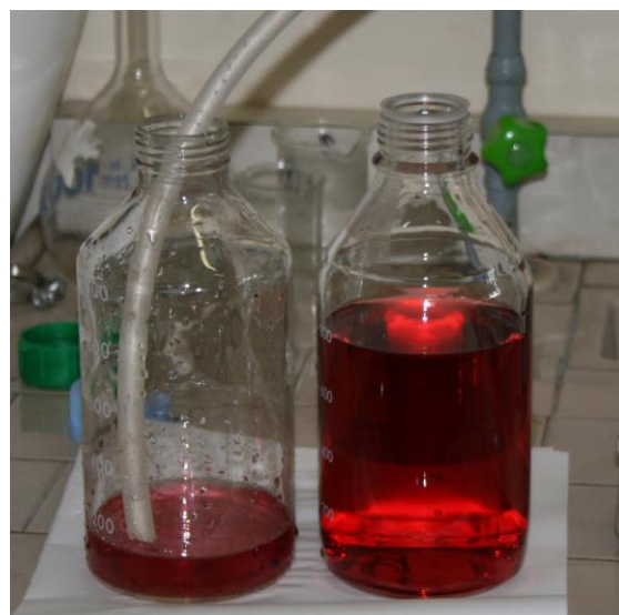
Fig.5: filtrato di MF con membrane ceramiche a partire dall'estratto grezzo di vinacce
